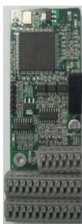
UVW inkrementális PG kártya HD2-E-PGI
