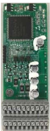
24V inkrementális PG kártya HD2-E-PGIM24
